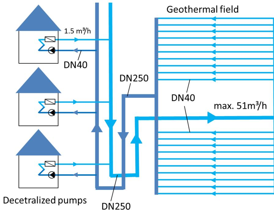
Figure 3: Hydraulic scheme of Wüstenrot case (Brennenstuhl, 2017).
